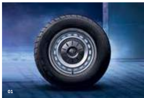
01 Стальные диски 6.5 J × 16 серебристого цвета с пластиковыми декоративно-защитными колпаками на ступицах, шины 205/75 R 16 C. | KA | PR | Ш |
