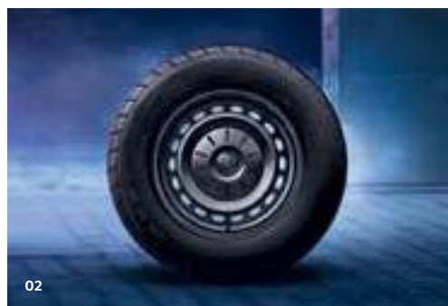
02 Стальные диски 6 1/2J × 16 чёрного цвета с пластиковыми декоративно-защитными колпаками на ступицах, шины 205/75 R 16 C. | KA | PR | Ш |
