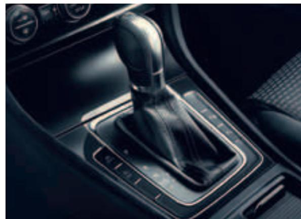
DSG осуществляет переключение автоматически и без разрыва потока мощности на предварительно уже включённую следующую передачу.
