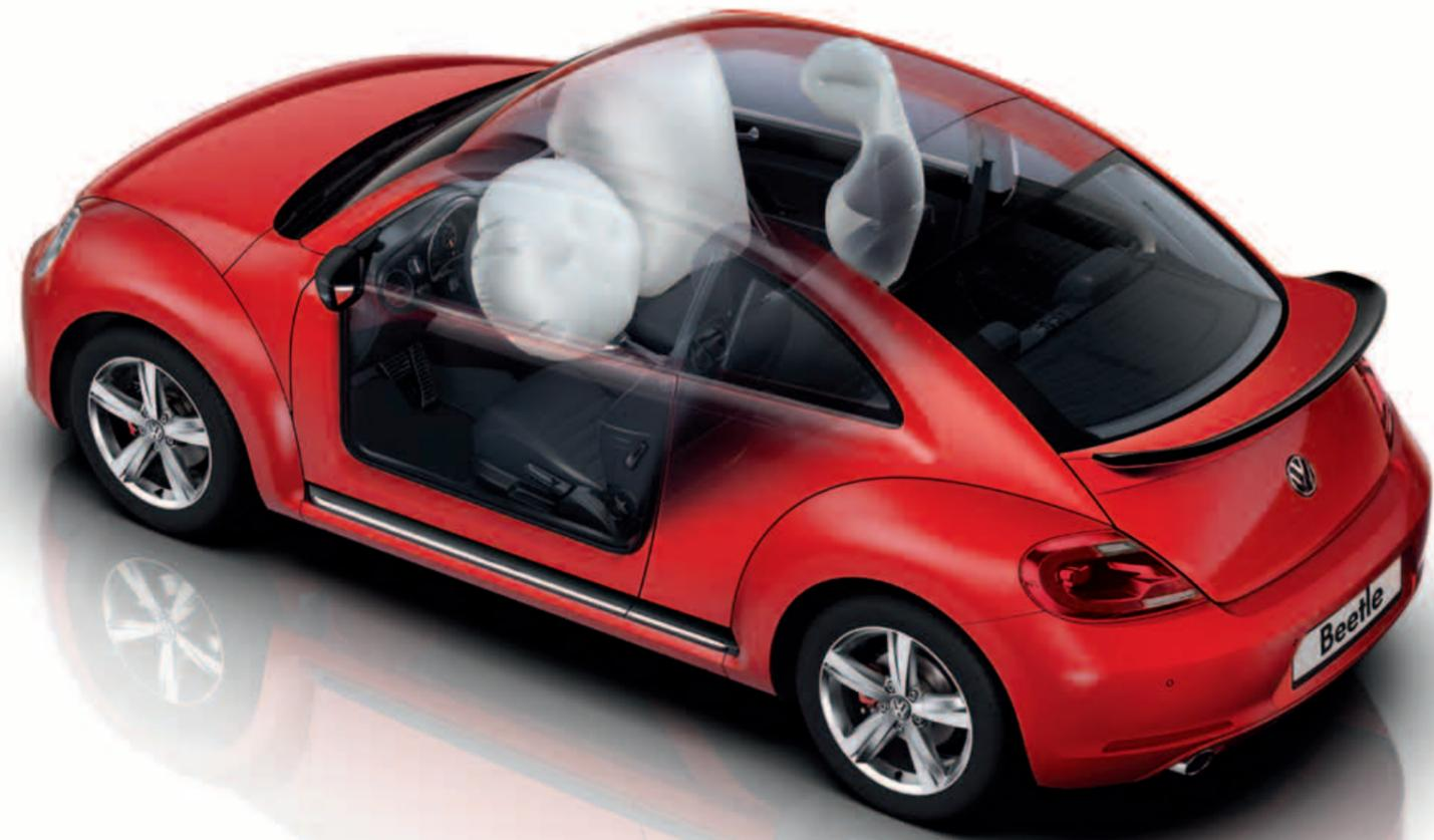
В стандартную комплектацию включены подушки безопасности для водителя и переднего пассажира с возможностью отключения пассажирской подушки, и комбинированная система подушек безопасности для защиты головы и боковой защиты передних пассажиров. В случае столкновения подушки безопасности срабатывают за несколько миллисекунд. За счёт этого удаётся значительно повысить безопасность при столкновениях. | **S**
