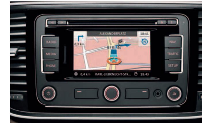
**Радионавигационная система «RNS 315»** с цветным дисплеем, приводом CD, сенсорным дисплеем, поддержкой формата MP3, динамическим ведением по маршруту, разъёмом AUX-IN, слотом для карт памяти SD и предустановленными картами России. | **SO**
