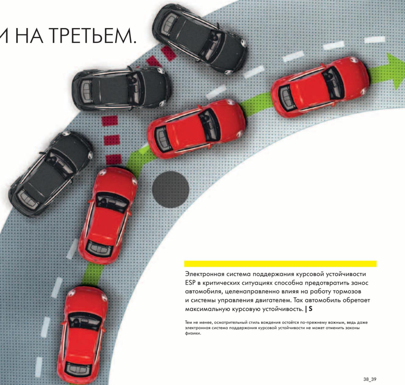
Электронная система поддержания курсовой устойчивости ESP в критических ситуациях способна предотвратить занос автомобиля, целенаправленно влияя на работу тормозов и системы управления двигателем. Так автомобиль обретает максимальную курсовую устойчивость. | **S**
