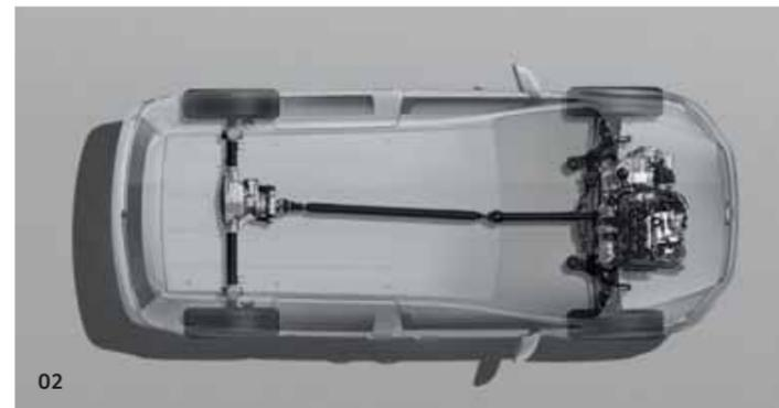
**02 Принцип работы 4MOTION.** При движении в нормальных условиях большая часть крутящего момента уходит на переднюю ось. Тяга на задней оси увеличивается по команде управляющей электроники. В замкнутом состоянии, например на льду, муфта работает как блокировка межосевого дифференциала, позволяя каждому из четырёх колёс реализовать максимум своих возможностей.
