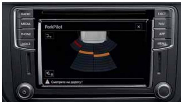
**Парковочный ассистент (парктроник).** Датчики, устанавливаемые спереди и сзади, предупредят о препятствии на пути машины. При наличии в Caddy инфомедиа-системы с цветным экраном на него будет выведена наглядная схема обстановки.
