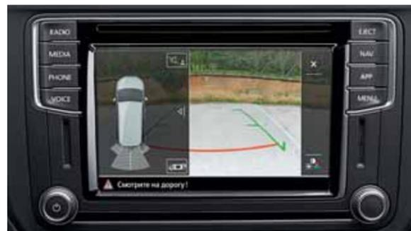
**Камера заднего вида Rear View.** Существенно облегчает движение задним ходом в ограниченном пространстве. Изображение с динамическими линиями, показывающими предполагаемую траекторию, выводится на экран инфомедиа-системы. Камера заднего вида доступна только на Caddy с подъёмной задней дверью.
