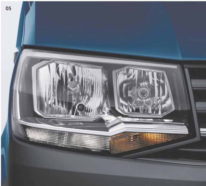
05 Улучшенные галогеновые фары. Фары с раздельными секциями дальнего и ближнего света (лампы H7). Обеспечивают более эффективное освещение в обоих режимах работы. Входят в пакет «Свет и обзор Plus». | KA | KO |
