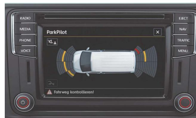
**Парковочный ассистент (парктроник).** Датчики, устанавливаемые спереди и сзади, предупреждают о препятствии на пути машины. При наличии в Transporter инфомедиа-системы с цветным экраном на него будет выведена наглядная схема обстановки. | KA | KO |
