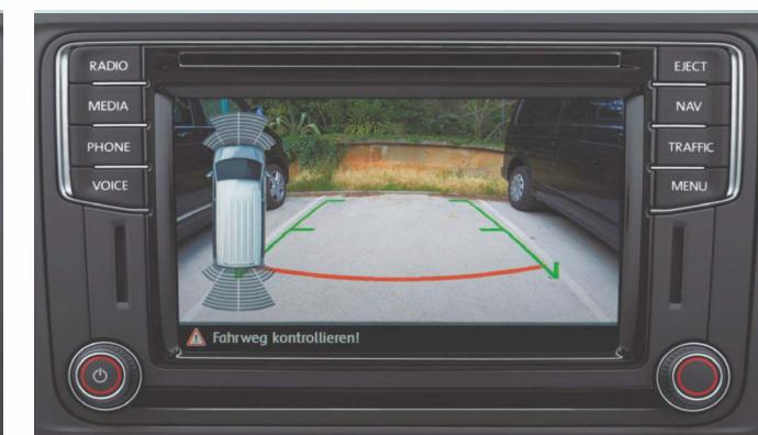
**Камера заднего вида Rear View.** Существенно облегчает манёвры на тесной парковке и движение задним ходом в ограниченном пространстве. Изображение с камеры выводится на экран инфомедиа-системы. | KA | KO |
