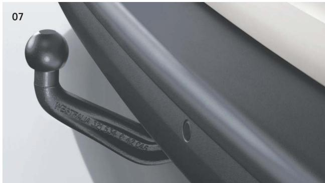
07 Съёмное тягово-цепное устройство (фаркоп). Существенно расширяет транспортировочные возможности автомобиля. Быстроштычная конструкция имеет защиту от кражи. При заказе данной опции в системе ESP будет активирована функция стабилизации автопоезда. | KA | KO |
